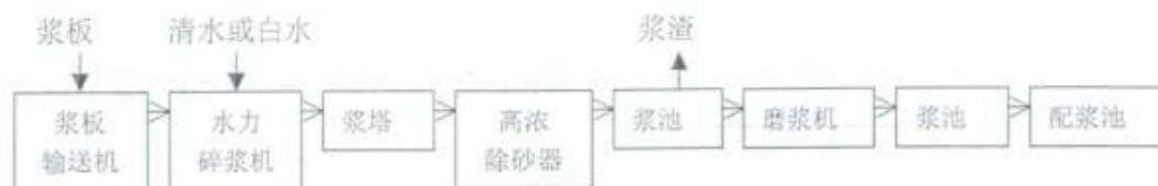
图 2.2-1 铜版纸打浆车间工艺流程图
