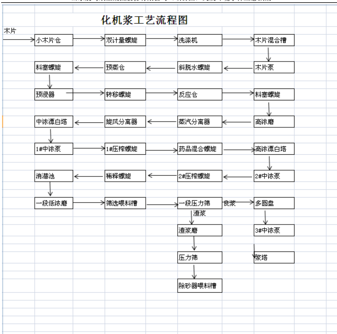
图 2.2-9 化学机械浆生产工艺流程图
